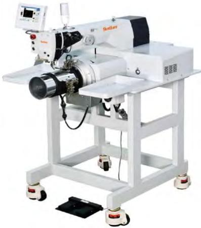
Машина с рукавной платформой применяется для обработки изгибающихся и угловых частей в изделиях из кожи, брезента, джинсовой ткани. Предназначена для окантовки кожгалантерейных изделий (сумок, обуви, и т.п.).
