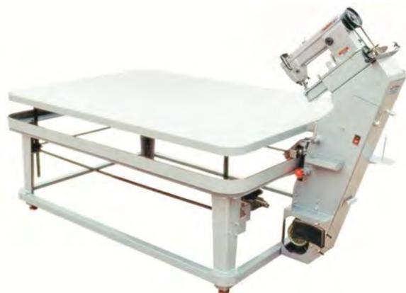
Машина для окантовки края матраса на базе одноигольной рукавной швейной машины челночного стежка с устройством для окантовки. Предназначена для окантовки края матраса, спальня мешков, палаток и т.п. Изменение высоты стола осуществляется механическим способом. Управление шьющей головой и регулирование скорости перемещения шьющей головы вокруг стола, в том числе при угловом замедлении, осуществляется в ручном режиме.
