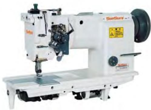
Предназначены для пошива изделий из различных по свойствам материалов, в том числе плотных и тяжелых, многослойных материалов и кожи, а также труднотранспортируемых. Оптимально подходит для настрочивания отделочных строчек, деталей, расстрачивая швов.
