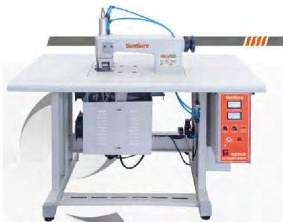
Промышленные машины для выполнения декоративного узора методом ультразвуковой резки. Предназначены для декорирования края изделия, вырезания мелкого узора или деталей, декорирования верхней одежды, нижнего белья, занавесок, накидок и покрывал.
