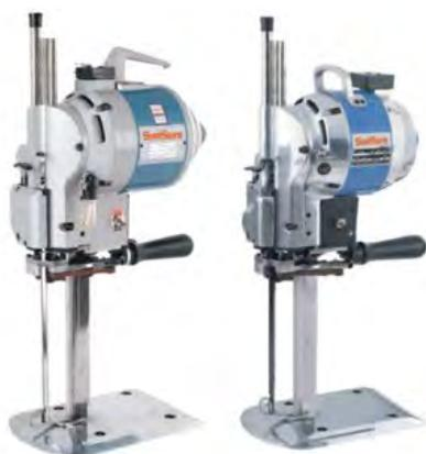
Вертикальные раскройные ножи с сервоприводом и автоматической заточкой для раскроя деталей и разрезания настилов высотой до 160 мм из легких и неплотных материалов (трикотажные, хлопковые, шелковые, шерстяные, костюмные).
