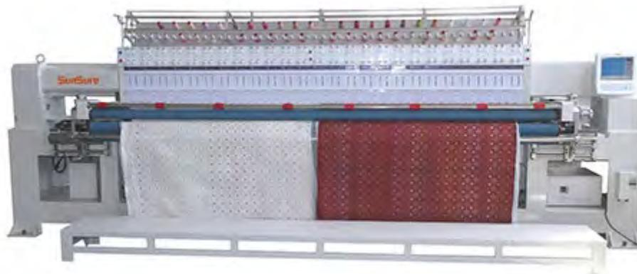
Высокоскоростные стегально-вышивальные секционные машины челночного стежка с вращающимся челноком для высокоточной декоративной простёжки материалов плотностью до 1500 г/м<sup>2</sup>. Машины оснащены программой цифрового управления, уникальным вращающимся челноком и независимыми игловодителями. Увеличенный объём нижней нити до 120 метров.
