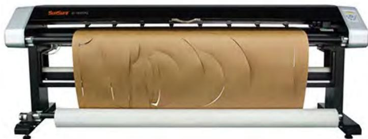
Машины для струйной печати с функцией резки представляют собой многофункциональную машину для печати и раскроя моделей одежды. В машинах используется чернильный картридж общего типа HP45, чернильная головка одноразовая, не требует
