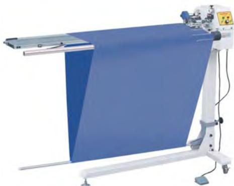
Промышленные машины для нарезания бейки предназначены для одновременного изготовления одной полосы из материала, предварительно сшитого в рукав или кругловязаного трикотажного полотна. Подходят для нарезания бейки из легких трикотажных материалов и тонкой ткани, а также для плотных материалов и кожзаменителя.
