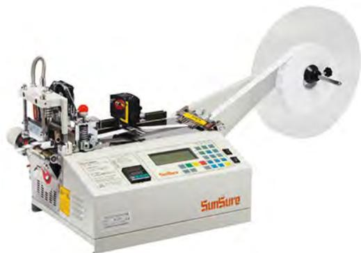
Автоматические машины с антистатическим приспособлением для нарезания горячим ножом тесьмы, шлевки, трубки, пластиковых молний, эластичных лент и липучки из легких и средних материалов. Не оставляет бахромы на срезах.
