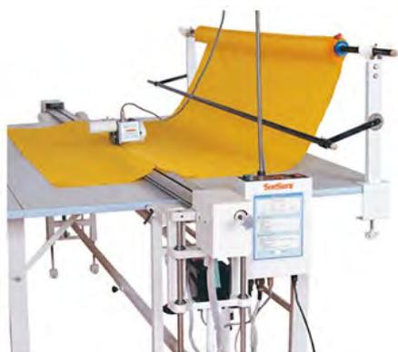
Концевая автоматическая отрезная линейка служит для отрезания дисковым ножом размотанной из рулона ткани и прижима ее к столу в процессе формирования настила. Отрезание и возвращения ножа происходит автоматически.
