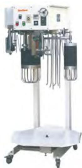
Станки для нарезки полос из ткани с цилиндрическим ножом. Используются для резки ткани, полотна, эластичной ткани, ткани из полиэфирно-хлопчатобумажной смеси. Можно резать тонкие, средние и тяжелые материалы.
